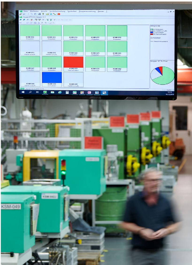
Wesentliche konzentrieren: auf Unvorhergesehenes wie Maschinenausfälle, Werkzeugbrüche oder kurzfristige Änderungen von Aufträgen. Nur dann greifen sie manuell ein. Außerdem können sie Alternativen simulieren, die zunächst nicht an die Fertigungssteuerung übertragen werden.
